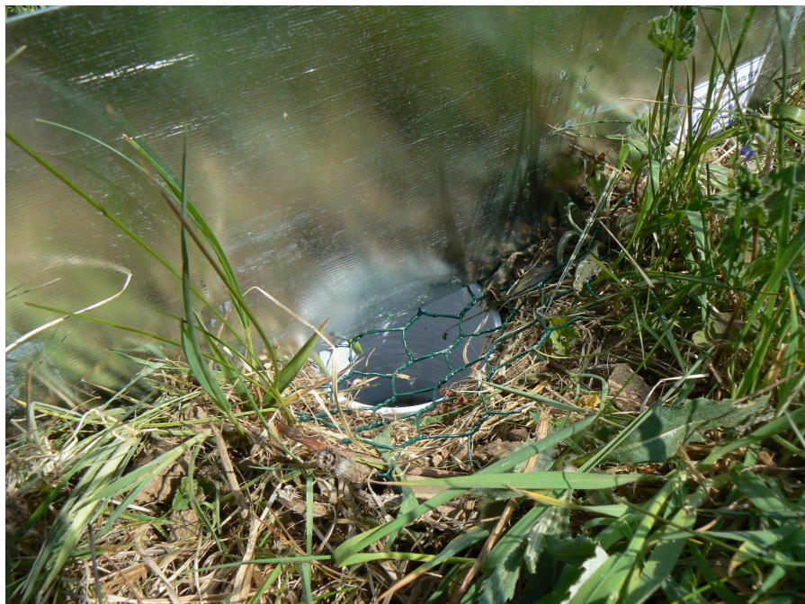
Obrázek 4: Modifikovaná zemní past s plechovou zábranou a pletivem tvořená zavařovací sklenicí s kelímkem s fixační kapalinou.
