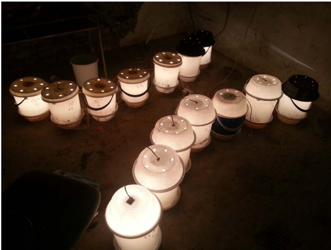
Extrakce bezobratlých z podzemních návnadových pastí za pomoci Tullgrenů
