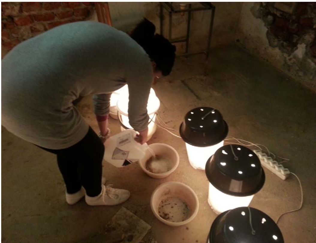
Průběžná kontrola a doplnění fixačního roztoku do Tullgrenů
